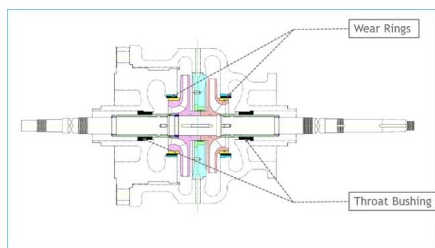
Fig. 1. Centrifugal Pump Wear Parts
